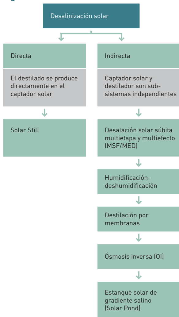
Figura 4.10.15. Desalinización solar térmica
