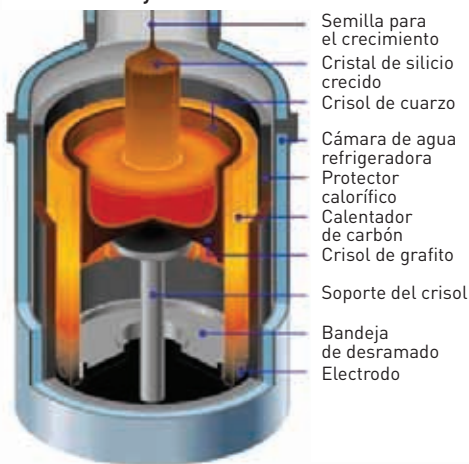
Figura 4.9.7. Cristalización por método Czochralsky
