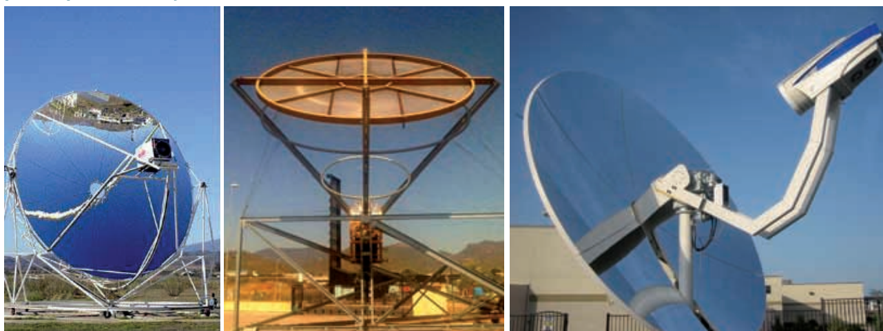
Figura 4.11.8. Instalaciones disco parabólicas en la Plataforma Solar de Almería (izquierda) y prototipos (centro y derecha)
